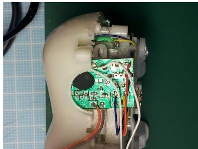
基板の格納位置が、背中上部の狭い位置にあり、基板の下部に尻尾を振るリンク機構があるため、片面実装で且つ高さの制約として 3 mm~5 mm 程度のクリアランスしかない。上部は背抜きしてあり、そ
